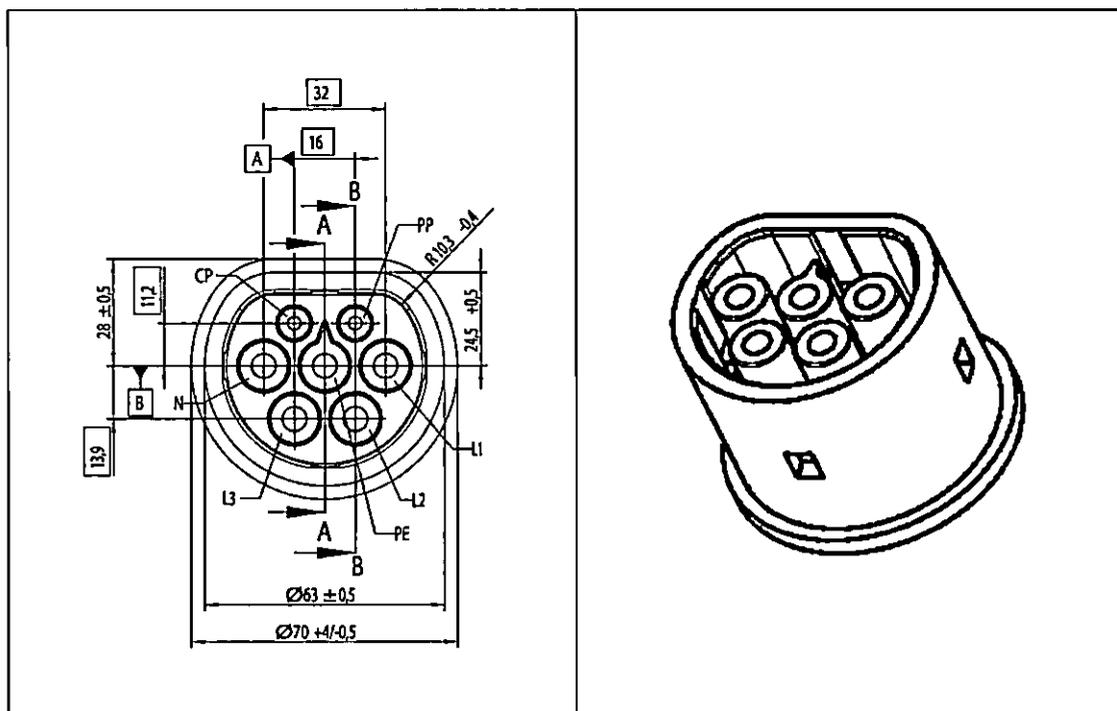
Gambar 3. Konektor Kendaraan (*Vehicle Connector*)
